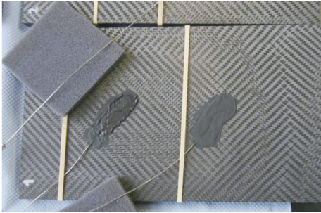
图 4 安装在陶瓷材料上的热电偶 Fig. 4 Thermocouples mounted on the panels
