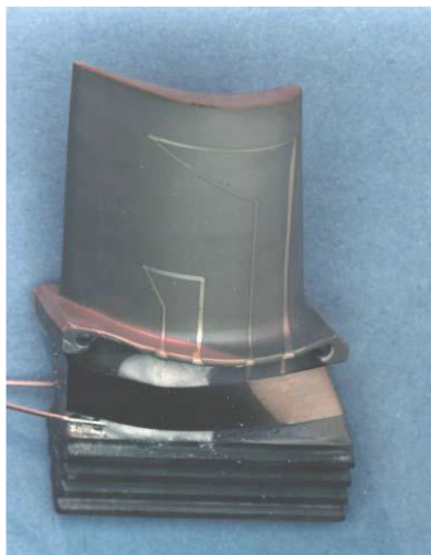
图 6 涡轮叶片上的薄膜热电偶
