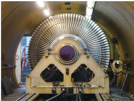
图 2 动平衡舱及试验转子实物
