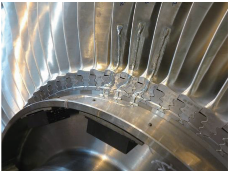
图 4 叶片上的应变拾振计
