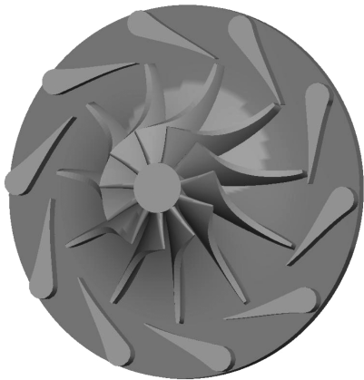
图 1 Sandia 实验室径流透平三维模型 [5] Fig. 1 3D model of SNL radial-inflow turbine [5]
