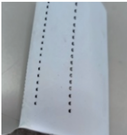
图 17 国内某预先研究发动机的先涂层后制孔的 涡轮叶片
