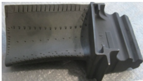
图 3 带扇型气膜孔的 CFM56 发动机涡轮叶片
