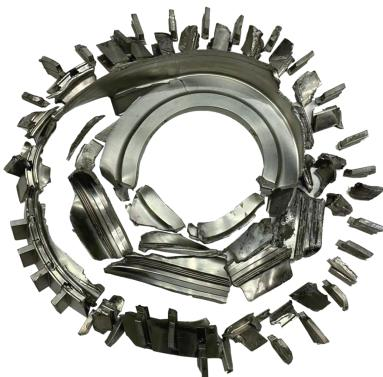
图 10 破裂试验后轮盘外貌
