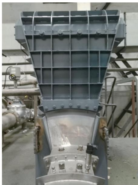
图4 间冷器部件试验台
