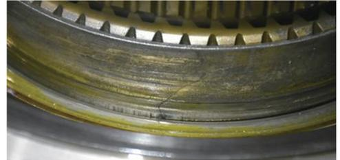
图 5 早期转子裂纹图
