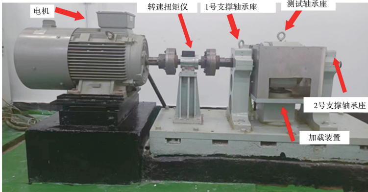
(b) SSB-100型船舶水润滑尾轴承试验台实物图
