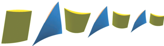
图 2 NASA 74A 压气机叶片建模结果
