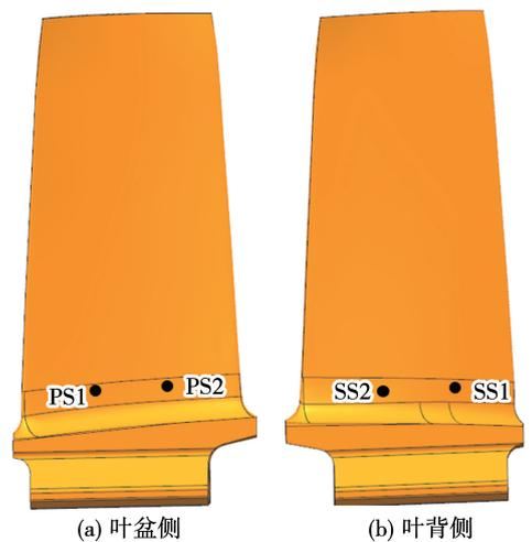
图 5 叶片应变测点布置图
