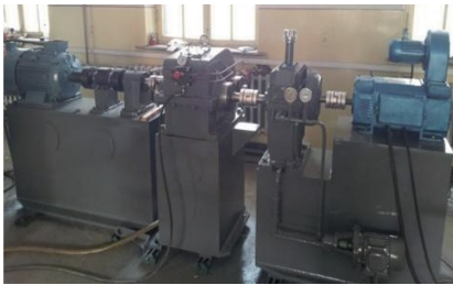
图 13 薄壁齿轮阻尼减振实验台
