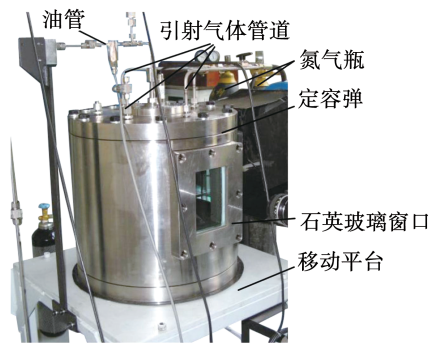
(a) 斯特林发动机喷雾试验台
