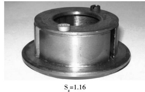
图 1 旋流器实物模型
