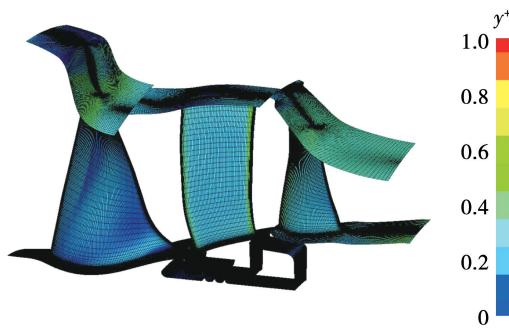
图 2 计算模型近壁面网格  $y^+$  云图
