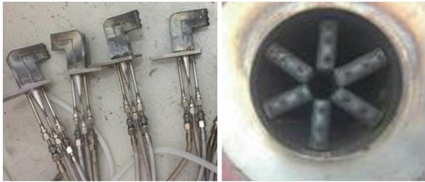
图8 燃气采样耙及布置方式
