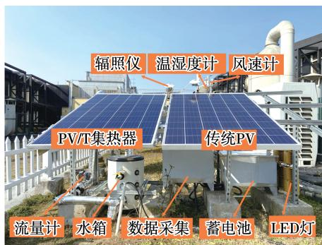
图 1 PV/T 实验系统图
