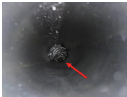
图7 后屏过热器下弯头积盐
