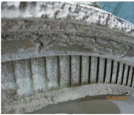
图 10 调节级喷嘴形貌
