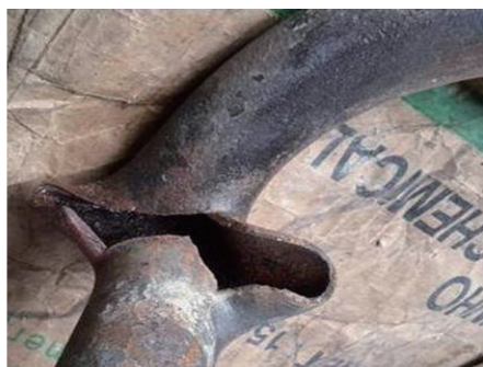
图8 后屏过热器爆管
