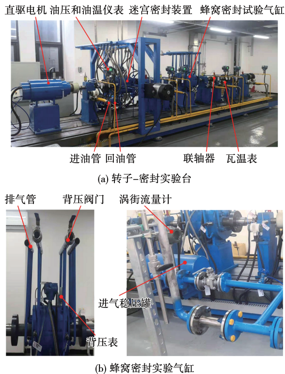
图 1 蜂窝密封泄漏试验测试装置
