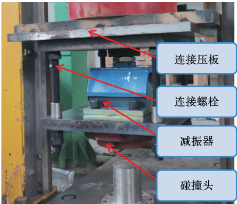
图 15 丁腈橡胶减振器落锤试验工装 Fig. 15 Drop weight test kit for nitrile rubber shock absorber
