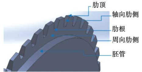
图 3 强化 TLC 管 3D 模型
