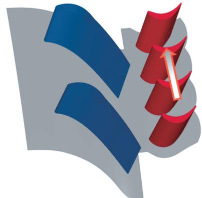
图 8 倒车涡轮不同旋转方向示意图
