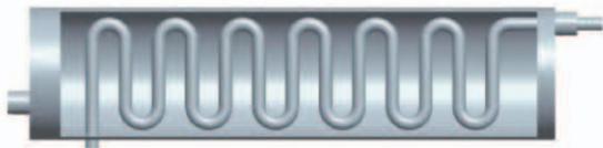
图 3 蛇形绕管换热器计算物理模型
