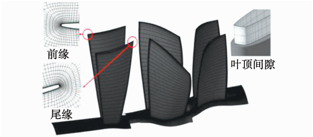
图 1 计算网格模型 Fig.1 Computational grid model
