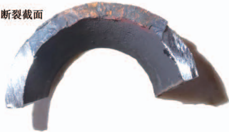
图5 裂纹截面 Fig.5 Crack section
