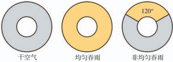
图 2 压气机进口雨滴分布形式
