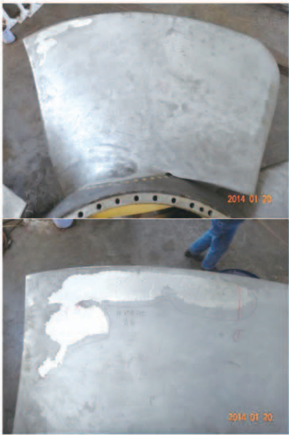
图 13 真机桨叶磨损照片 Fig.13 Photos of blade wear
