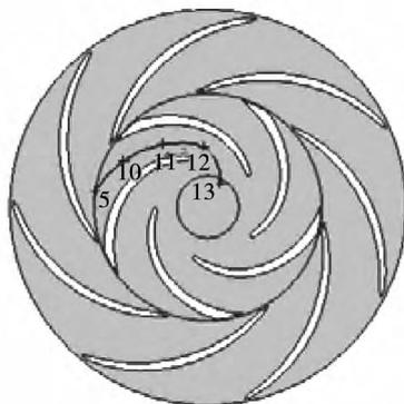
图4 不同位置处测点布置示意图
