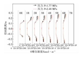
图 11 不同特征直线上 O 原子摩尔浓度 Fig. 11 Mole concentration of oxygen atom distributionalong different feature lines
