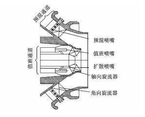
图 1 燃烧器示意图<sup>[12]</sup>
