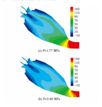
图 3 燃烧器中心截面速度分布/m • s<sup>-1</sup> Fig. 3 Velocity distribution in central cross section of combustor/m • s<sup>-1</sup>
