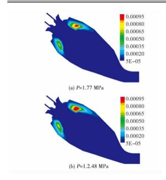
图 10 燃烧器中心截面热力型  $NO_x$  生成速率云图/kmol •  $m^{-3}$  •  $s^{-1}$
