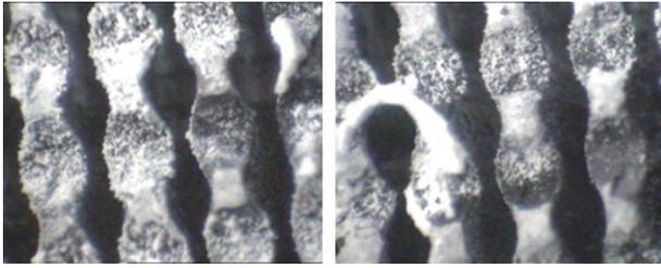
图 8 热水侧温度 70 °C 时 3 号平直斜翅管的污垢形貌
