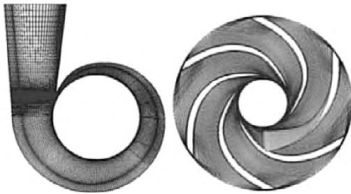
图 2 蜗壳和叶轮结构网格示意图
