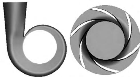
图1 蜗壳和叶轮的三维模型
