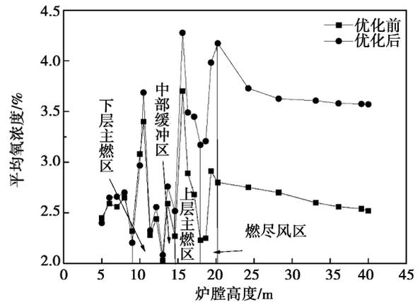
图 10 炉膛横截面平均氧浓度随炉膛高度变化曲线
