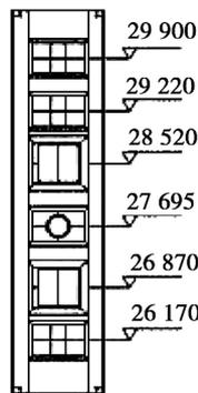
(b) 上层燃烧器喷口布置简图(mm)
