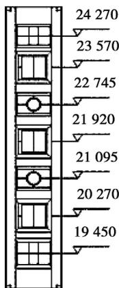
(c) 下层燃烧器喷口布置简图(mm)
