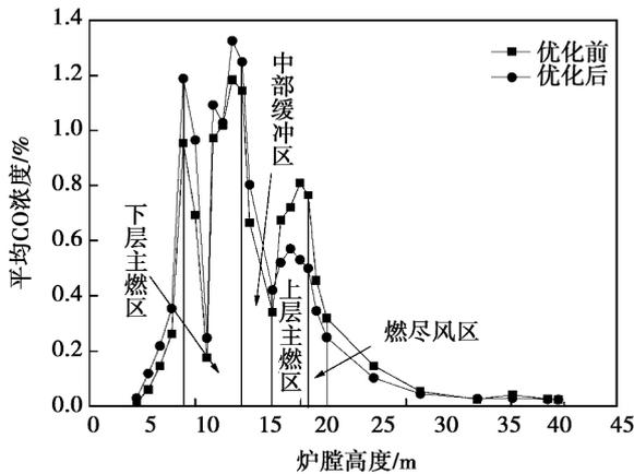
图 11 炉膛横截面平均 CO 浓度随炉膛高度变化曲线
