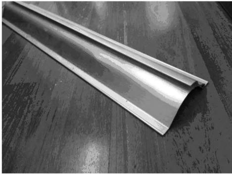
图 2 惯性级导叶实物图
