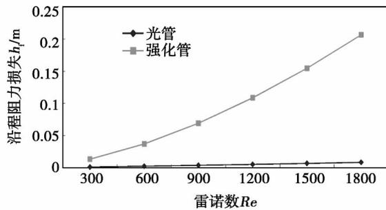
图 9 光管与强化管的沿程阻力损失  $h_f$  随雷诺数  $Re$  数的变化
