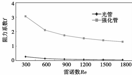
图 10 光管与强化管的阻力系数  $f$  随  $Re$  数的变化
