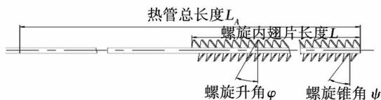
图6 内螺旋翅片剖视图
