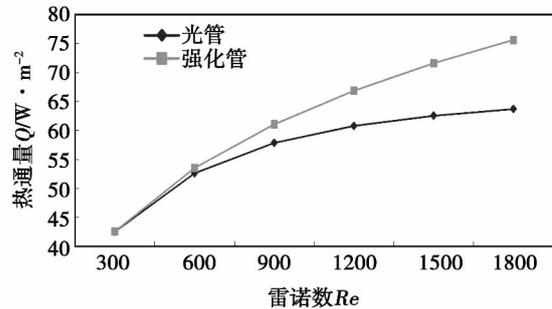
图 11 光管与强化管的热通量  $Q$  随  $Re$  数的变化
