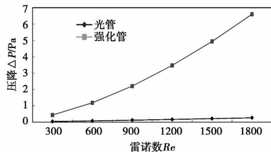
图 12 光管与强化管的压力降  $\Delta p$  随  $Re$  数的变化
