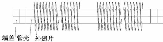
图4 气-气换热器热管
