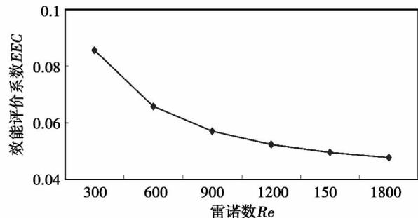
图 13 光管与强化管的  $EEC$  值随  $Re$  数的变化
