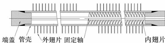
图5 具有内螺旋翅片的热管剖视图
