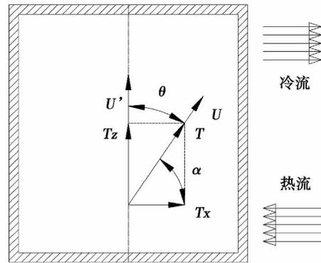
图1 热管内速度和温度平面矢量
