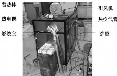
图 2 连续式蓄热燃煤实验装置
