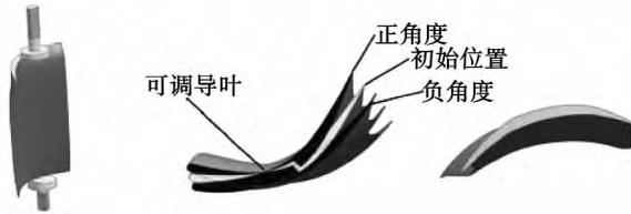
图2 导叶叶型及变安装角方式示意图
