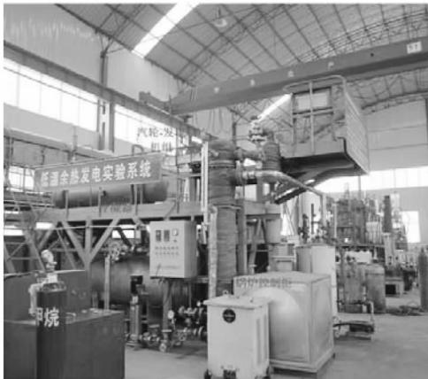
图 2 低温余热 ORC 发电实验系统
