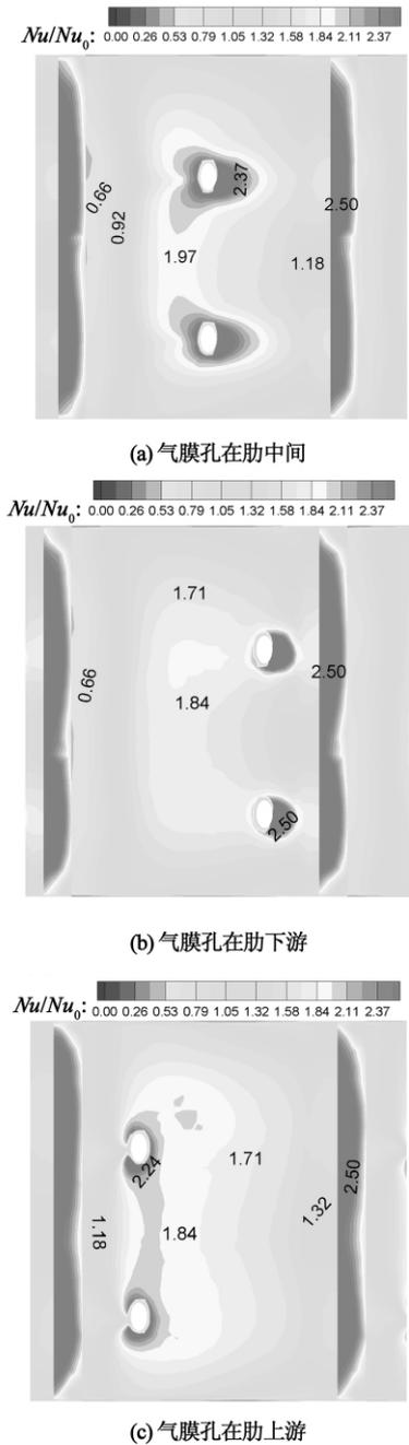
图 3 气膜孔在肋间不同位置处下壁面换热增强因子
