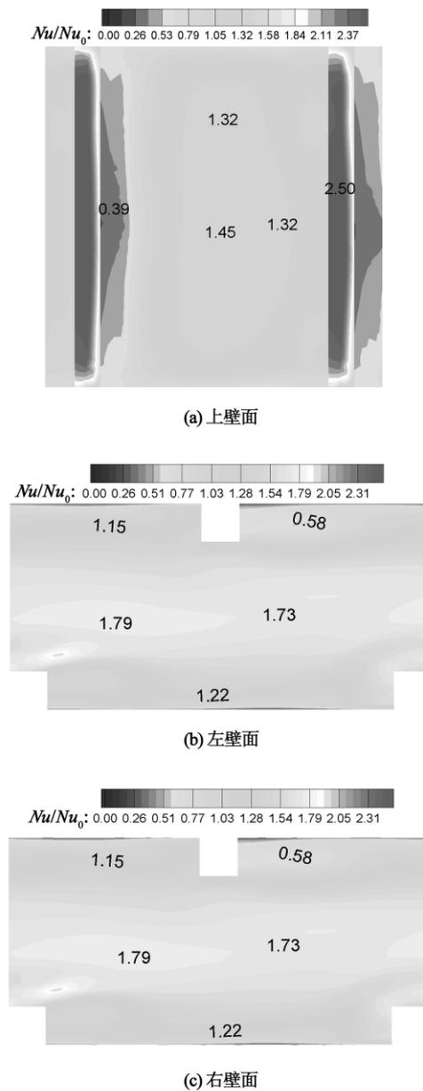
图 4 气膜孔在肋间上游时各壁面换热增强因子分布
