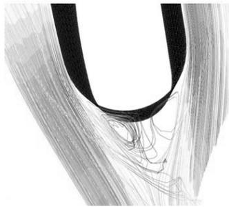
图 7 动叶栅尾缘尾迹涡迹线图
