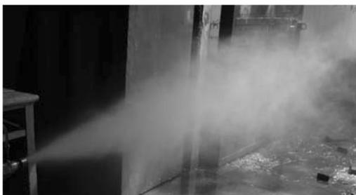
图 3 气流式喷嘴雾化效果
