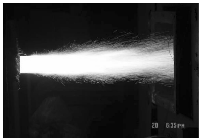
图 11 高温空气点火燃烧器出口火焰 [29]
