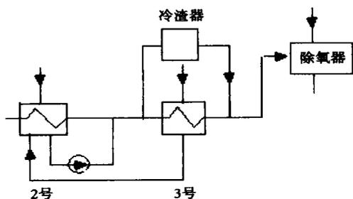
图3 冷渣器与3号低压加热器并联
