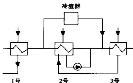
图2 冷渣器与2号低压加热器并联
