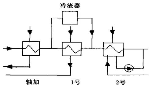
图 1 冷渣器与 1 号低压加热器并联
