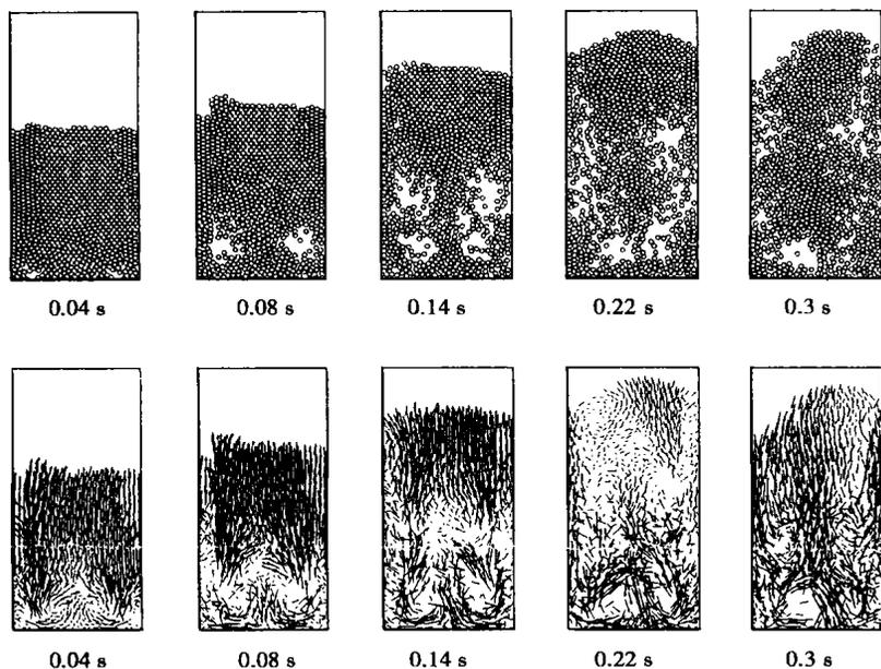
图 4 均匀布风流化床的 DEM 模拟
