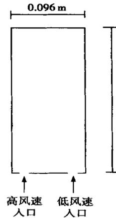
数值模拟时采用的流化床结构如图 1 所示。床宽为 0.096 m，床高为 0.4 m。流化床底部布置两个进口，宽度均为 0.012 m。其中高风速进口距左界面为 0.018 m，低风速进口距右界面也为 0.018 m。
