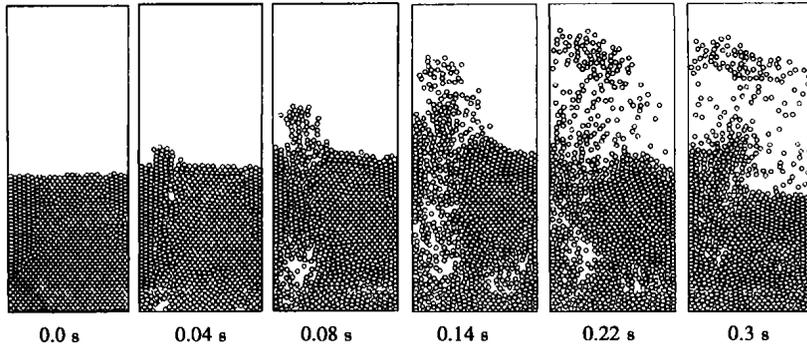
图 2 非均匀布风流化床的 DEM 模拟
