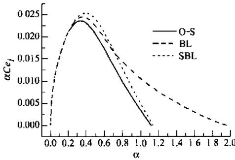
图 3 当雷诺数为 1 200, 流体为水时波的增长率和波数之间关系曲线
