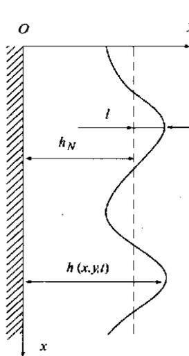
图2 波状液膜厚度示意图
