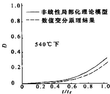
图 4 12Cr1MoV 钢在 540 °C 下的蠕变损伤曲线
