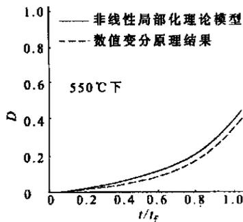
图 2 2.25Cr1Mo 钢在 550 °C 下的蠕变损伤曲线
