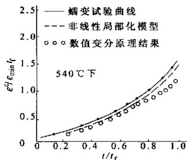
图 3 12Cr1MoV 钢在 540 °C 下的蠕变曲线
