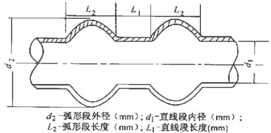
图 1 双层波纹管换热元件
