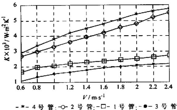
图4 总传热系数随流速变化的测试曲线
