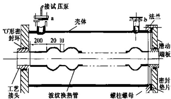
图2 外压试验装置
