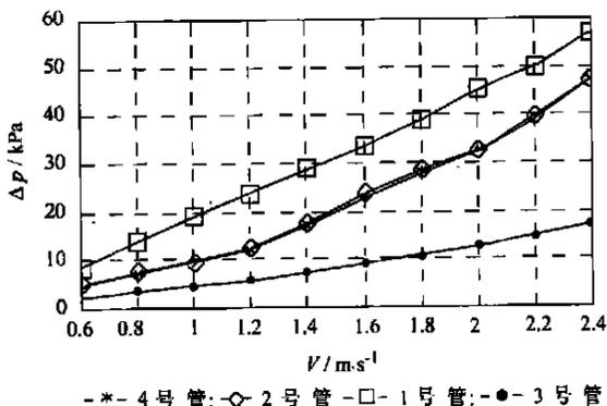
图5 各管管内压力降随流速变化的测试曲线
