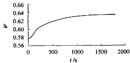
图 5 水冷壁容积含水率变化
