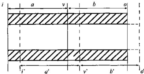
图 1 水冷壁中的与控制体划分与移动示意图
