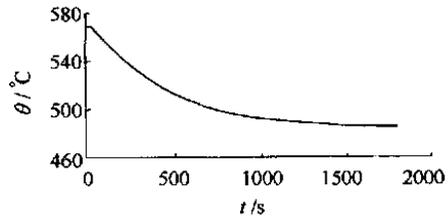
图 4 再热器出口汽温变化
