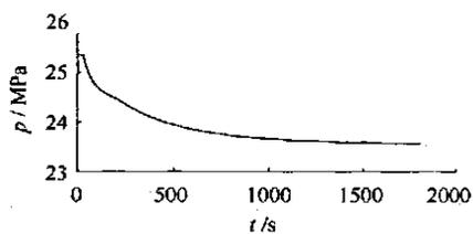
图 6 新蒸汽压力变化
