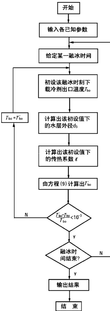
图 2 模型求解程序框图
