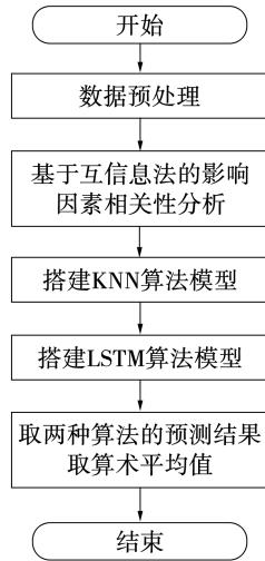
图5 KNN-LSTM结合算法步骤
