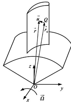
图 1 汽轮机叶片运动模型
