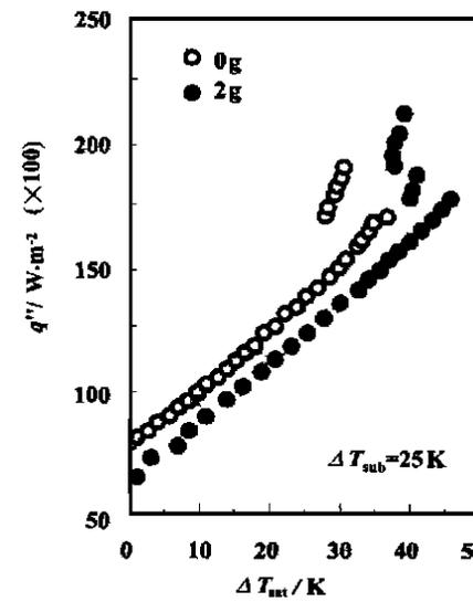
图 5 光照射对沸腾换热的影响
